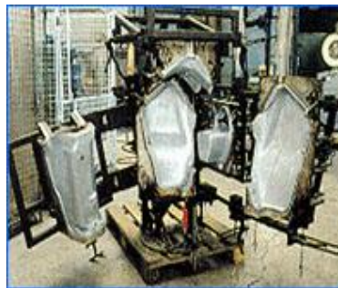
Herstellung von PE-Rotationsteilen mit einem semipermanenten ACMOS-Trennmittel
