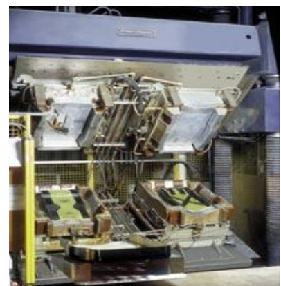
Abformung CFK-Teile unterschiedlichster Größe ohne Gelcoat mit einem semipermanenten ACMOS-Trennmittel
